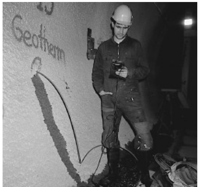
Temperaturmessung im Sondierstollen Pioramulde (NEAT)
