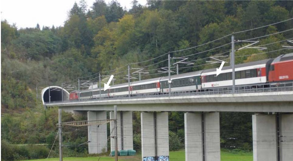
Bild 4: Testzug der Messfahrten – Pfeile markieren die Messpositionen (vor Tunnel Murgenthal: Nutzung des Tunnels Murgenthal für Ausrollversuche)
