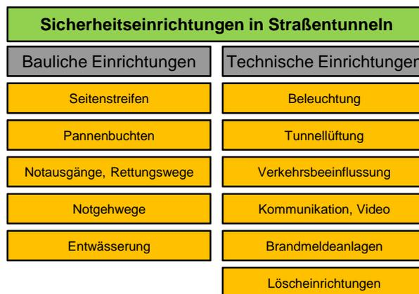
Abbildung 1. Sicherheitseinrichtungen im Straßentunnel
