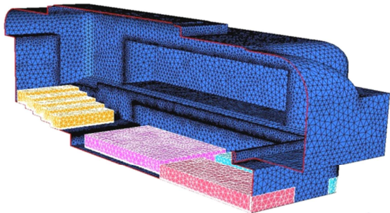
Modello CFD della Tonhalle di Zurigo (modello dimezzato)
