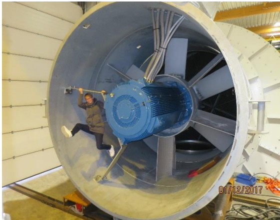
Accettazione in fabbrica di un ventilatore assiale
