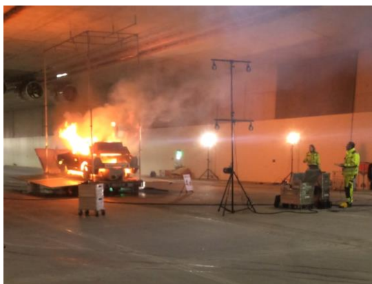
Prova di incendio per la verifica delle velocità dei flussi d'aria e delle propagazioni di fumi
