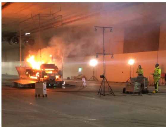
Essai au feu pour vérifier les vitesses d'écoulement d'air et de la propagation de la fumée
