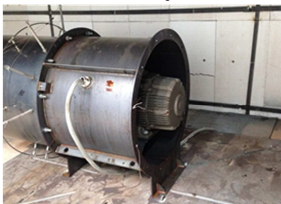
Ventilateur de jet après les tests sur la température
