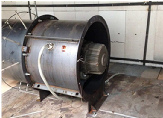
Jet fan after heat test
