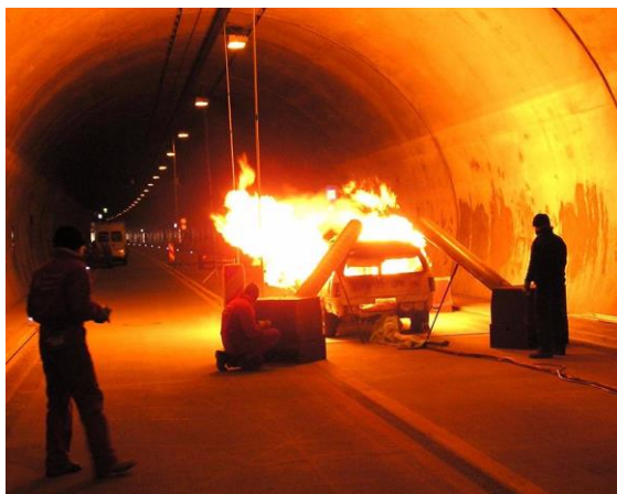
Prova d'incendio nella canna sud della galleria
