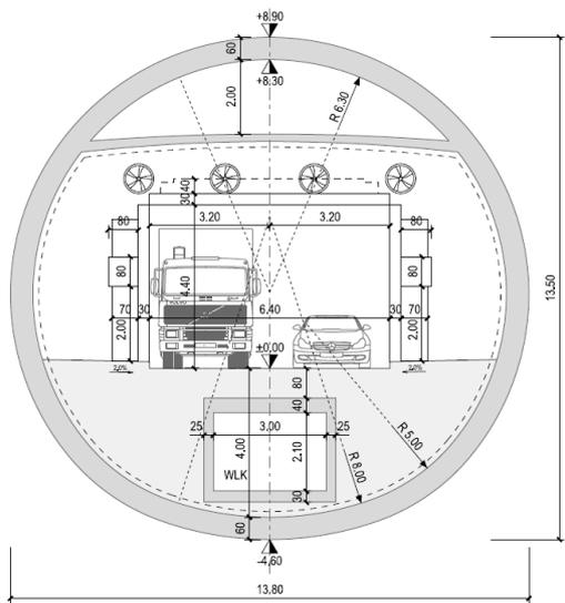
Profil transversal creusé avec gaine d'extraction d'air et ventilateurs de jet
