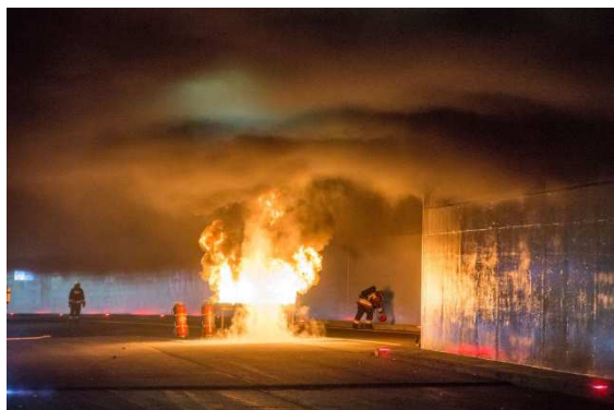
Prova d'incendio prima della messa in funzione del primo lotto di lavori
