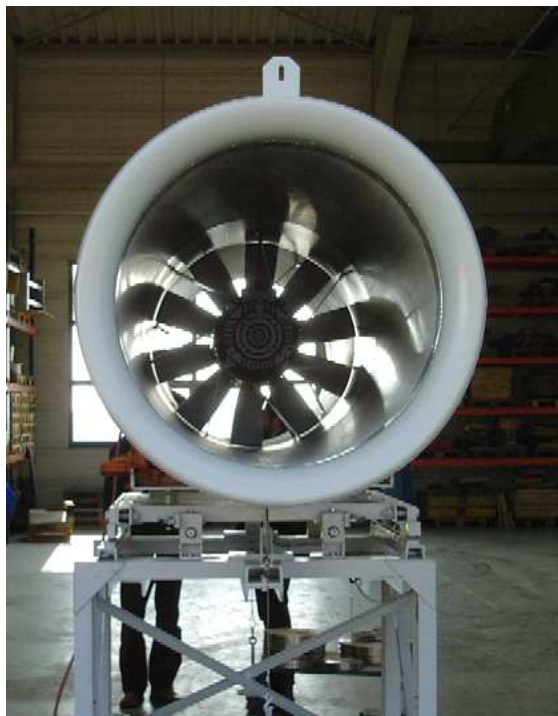
Collaudo in fabbrica dei ventilatori a getto
