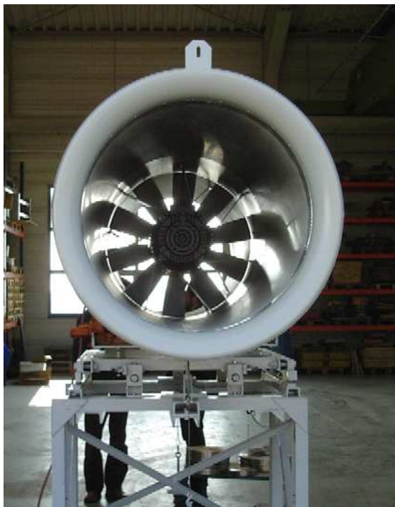
Enlèvement à l'usine des ventilateurs de jet
