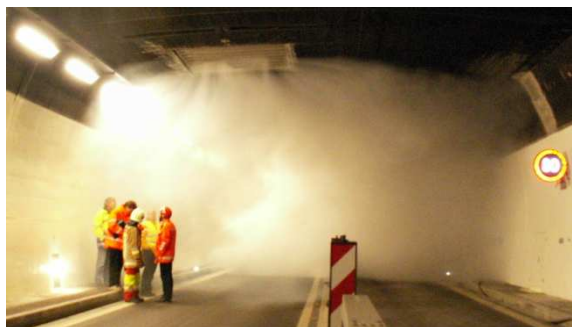
Prova d'incendio nella galleria Lopper
