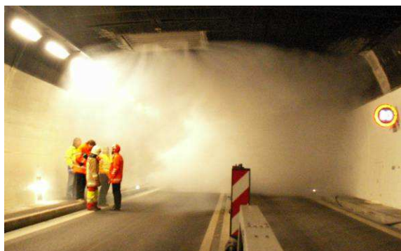
Essai de dégagement de fumée dans le tunnel du Lopper
