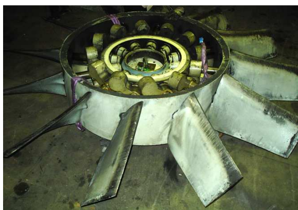
Girante di un ventilatore di aspirazione dell'aria
