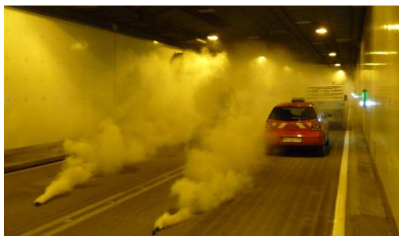
Prova con fumi caldi durante la fase di messa in funzione
