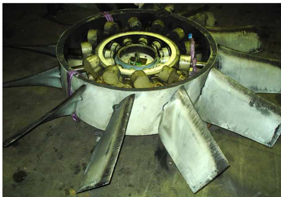
Impeller of old exhaust fan
