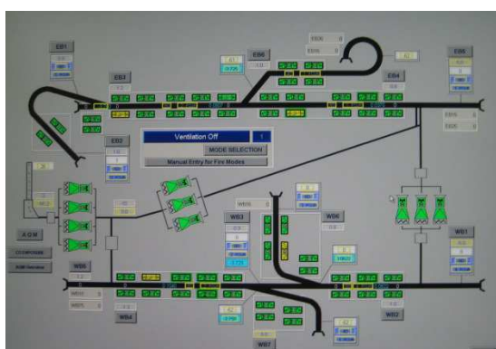
Schema di ventilazione nel sistema di gestione
