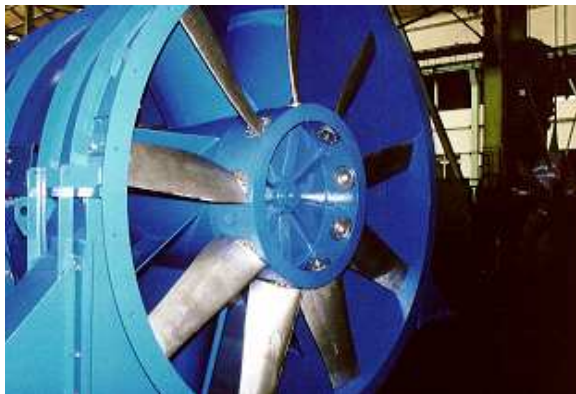
Ventilateur (air frais/pollué, désenfumage)
