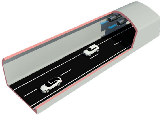
Ventilatori a getto nella sezione trasversale di una galleria
