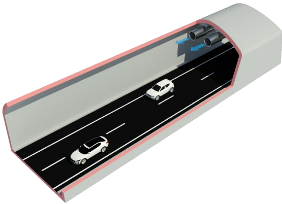
Ventilateurs à jet dans la section transversale du tunnel
