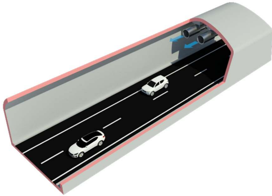
Ventilateurs à jet dans la section transversale du tunnel
