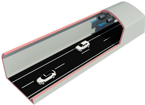
Ventiladores de chorro en una sección transversal de túnel
