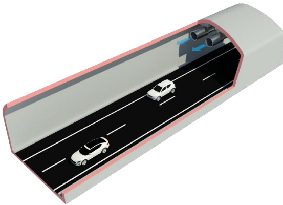
Strahlventilatoren in einem Tunnelquerschnitt
