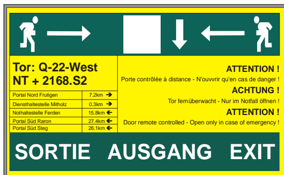
Cartello di segnalazione di via di fuga, quale esempio di misure di autosalvataggio
