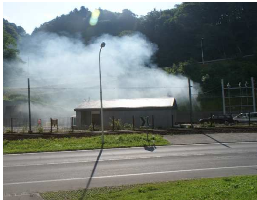
Fumée sortant par le portail sud lors d'un test sur les fumées
