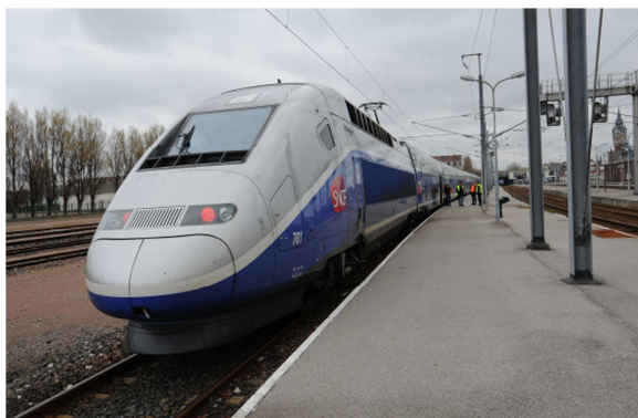
Il treno di prova TGV Duplex per la misurazione di corse a 360 km/h
