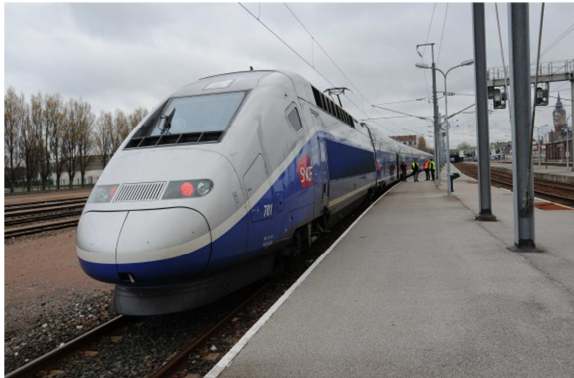
TGV Duplex de mesure lors de mesures effectuées sur un parcours à 360 km/h
