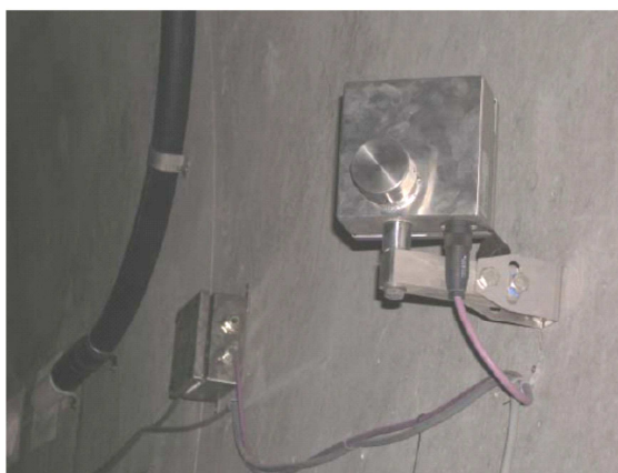
Unità emittente-ricevente di un sistema unidimensionale ad ultrasuoni per la misurazione senza contatto della velocità di flusso
