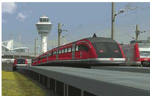
Ferrovia monorotaia a levitazione magnetica TRANSRAPID presso l'aeroporto di Monaco di Baviera
