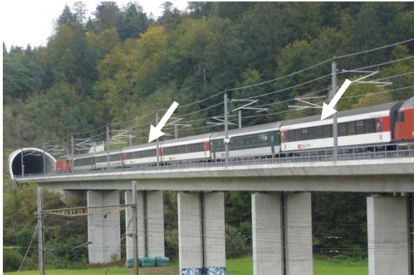
Messzug mit Messeinrichtung während der Einfahrt in den Tunnel Murgenthal (Pfeile markieren die Messpositionen)
