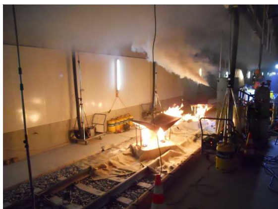
Prova di incendio reale e strato di fumo in corrispondenza del focolaio d'incendio
