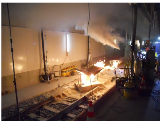
Essai d'incendie et stratification des fumées au droit du foyer
