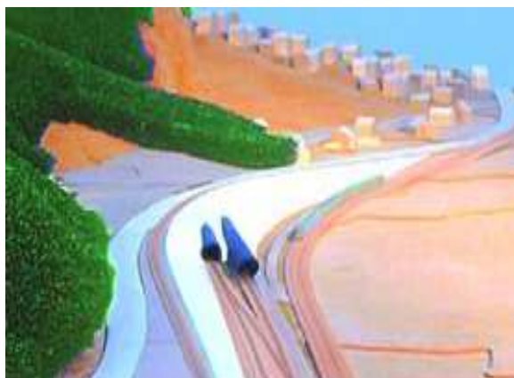
Modello per le prove in galleria a vento al fine di ottimizzare la disposizione dei portali
