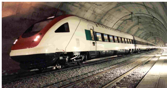
La circulation de trains à grande vitesse dans un tunnel (vue d'un ICN dans le tunnel du Grauholz) entraîne une contrainte en pression et des vents supérieurs.
