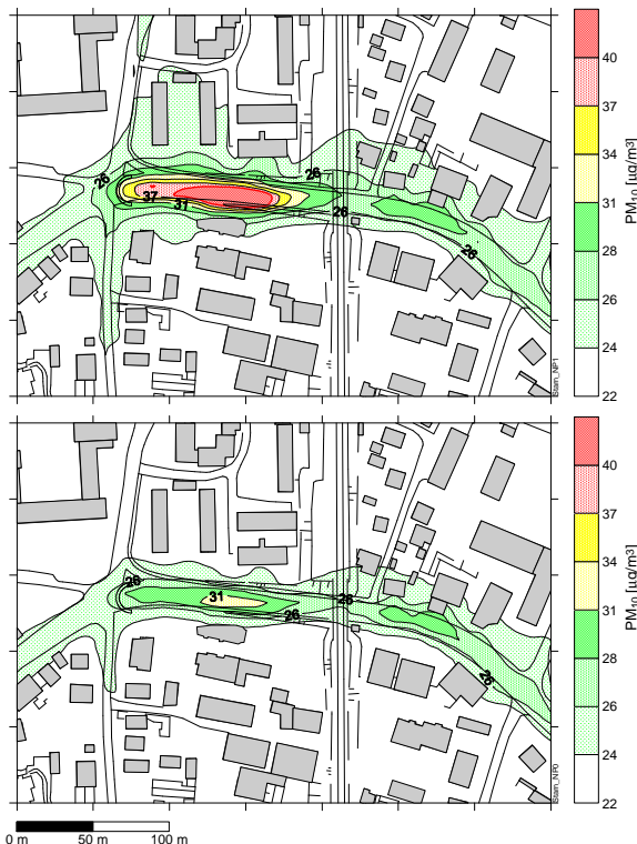
Valore medio annuo 2012 della concentrazione di PM10 in corrispondenza del portale nord senza (sopra) e con aspirazione (sotto), calcolato con MISKAM
