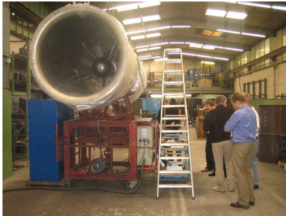
Werkabnahme an einem Strahlventilator
