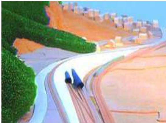
Modell für die Windkanalversuche zur Optimierung der Portalanordnung
