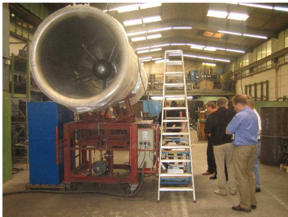
Werkabnahme an einem Strahlventilator
